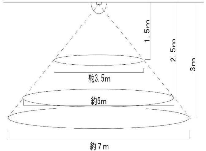
本センサーは、赤外線(熱)の変化を検知する方式となっています。
