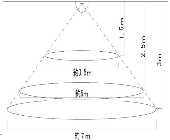
本センサーは、赤外線(熱)の変化を検知する方式となっています
